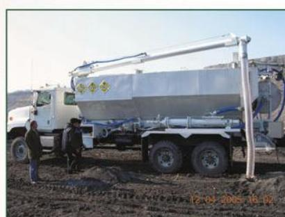
Смесительно-зарядная машина универсального типа предназначенная для заряжения обводненных и сухих скважин, грузоподъемностью от 6 до 20 тонн, в том числе на шасси-вездеходе.
